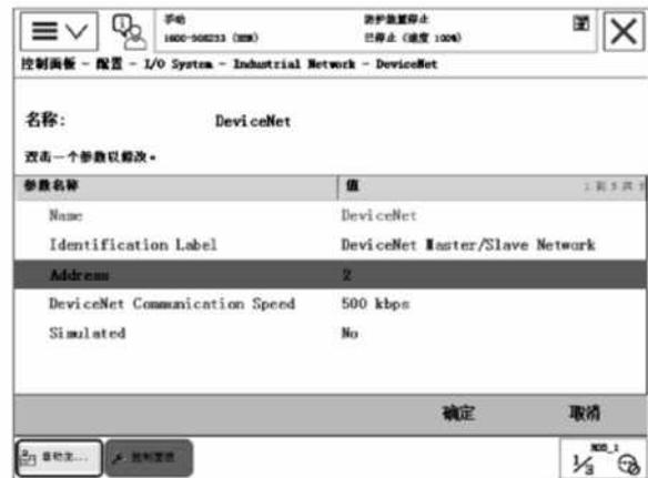
图 2 ABB 机器人通讯地址设置
