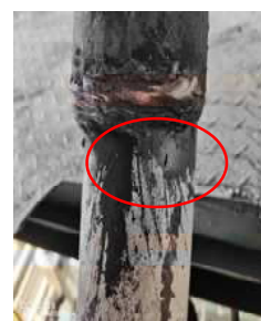
图3 再生器提升线测厚点简图 图4 斜管段磨穿部位图
