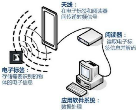
图 1 RFID 工作流程
