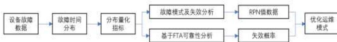
图 1 风机可靠性分析流程图
