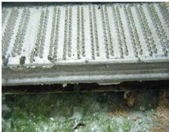
图 3 漏板换下后侧墙的挥发面貌
