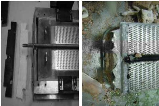
图 2 漏板使用前后底板边缘面貌对比
