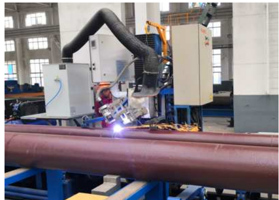
4.2.3-1 五轴数控切制作业线
