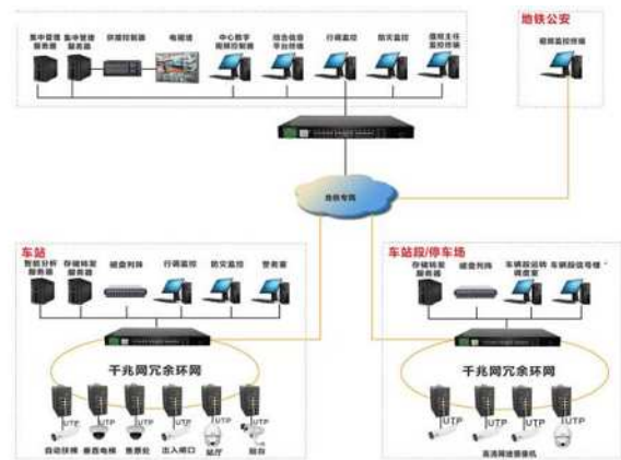
图1 地铁通信视频监控系统流程
