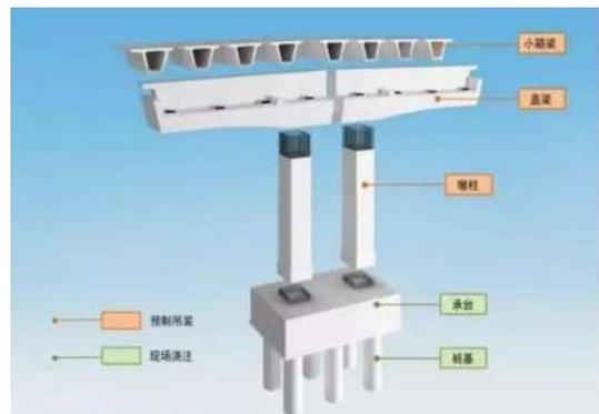
图1 预制拼装桥墩连接构造类型
