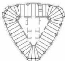
图1 标准层钢构件分布示意图
