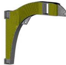
图5 基模型网格划分
