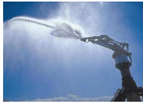
图1 高压喷雾降尘处理措施
