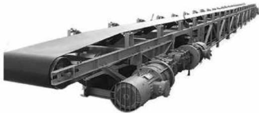
图1 带式输送机结构
