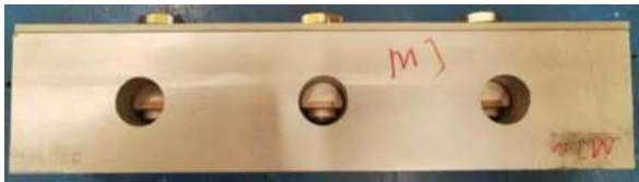
图7 MJ型桶形螺母实物
