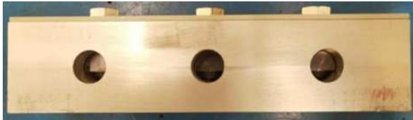
图6 M型桶形螺母实物
