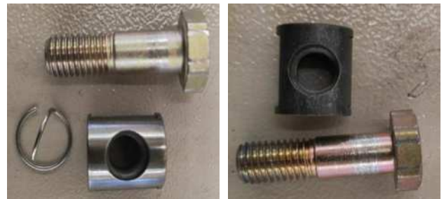
图10 桶形螺母及配套螺栓实物
