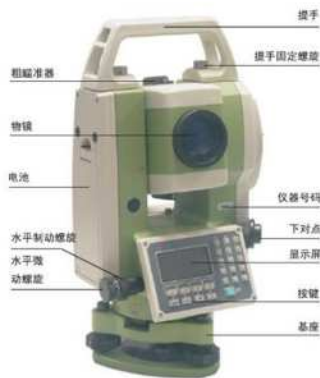
图1 全站仪结构示意图
