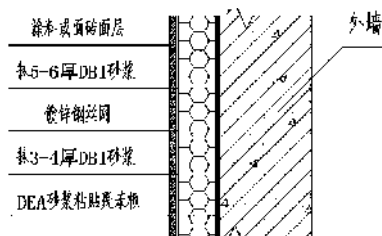
图1 保温层防渗漏
