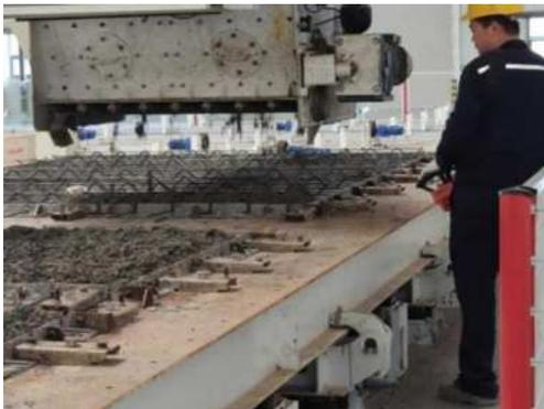
图 2.1 预制墙在振捣台平放浇筑
