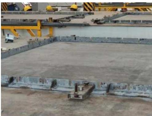
图 3.1 预制构件挡边侧模
