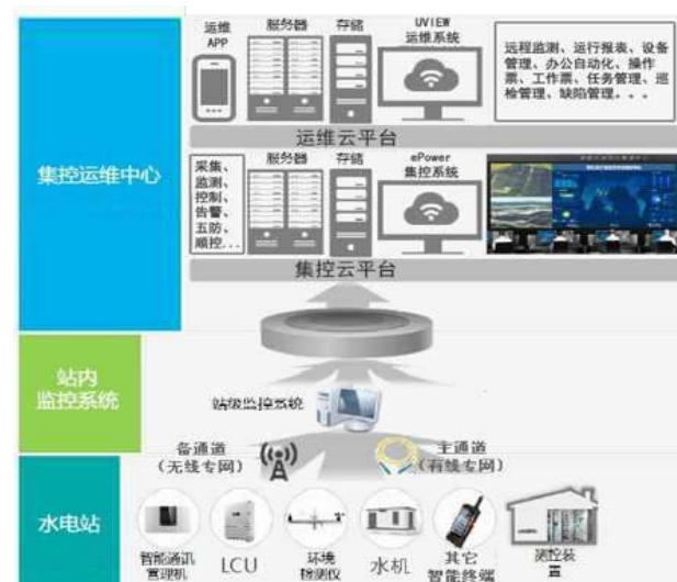
图2 集控运维系统总体方案全景图
