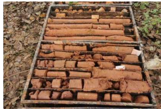
图 2 项目现场典型软土钻芯土样
