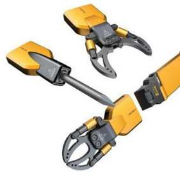
图 2 智能化机械臂替换接口概念图
