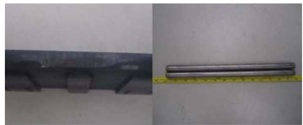
图6 拆检后的滑片、顶杆
