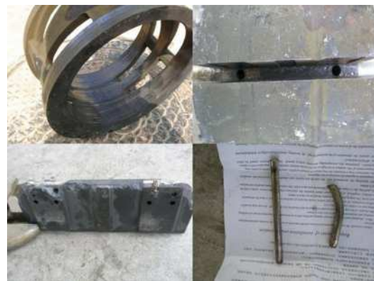
图2 损坏的定子、转子、滑片、顶杆
