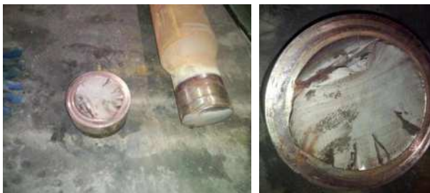
图4 1B磨拉杆2016年3月20日断裂位置图
