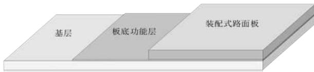
图1 装配式路面结构组合示意图
