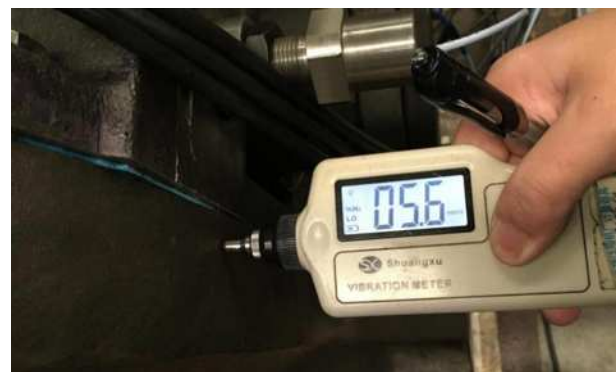
图1 试车时检测轴承振动超标
