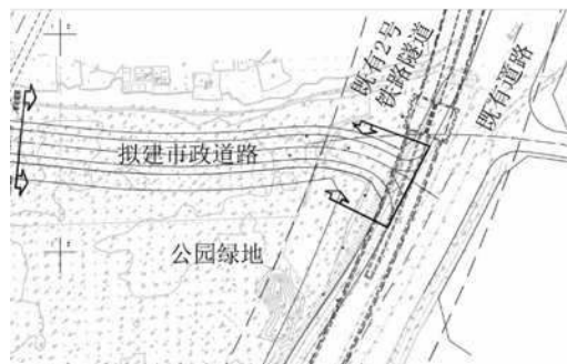
图 1 拟建工程与 2 号隧道的平面关系图
