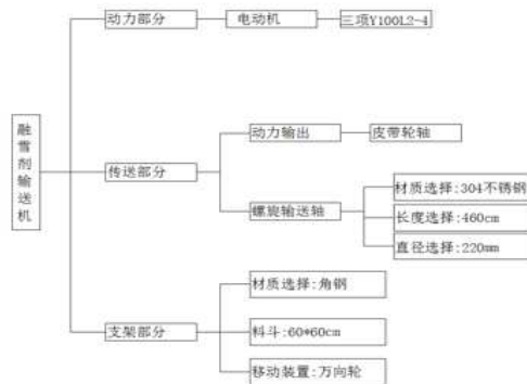
图 2 旋转式融雪剂输送机最佳设计方案
