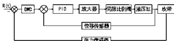
图 4 张紧装置的控制系统图
