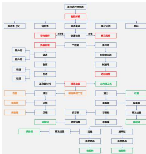
图 1 退役动力锂电池工业化回收工艺流程图
