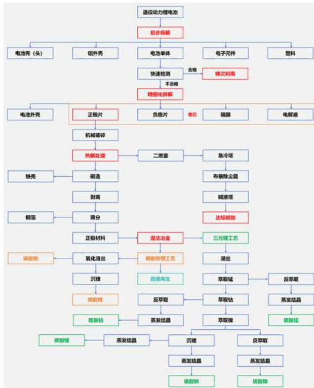
图 2 退役动力电池工业化回收工艺流程图
