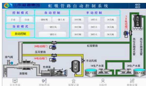
图4 虹吸管路自动控制系统
