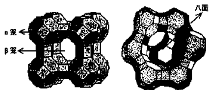
图 1 A 型分子筛晶体结构
