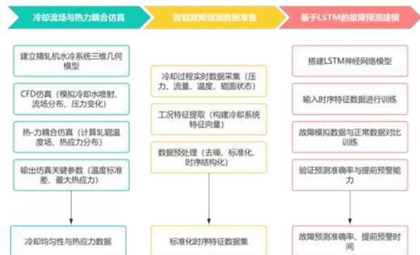
图 1 仿真实验与故障预测流程示意图
