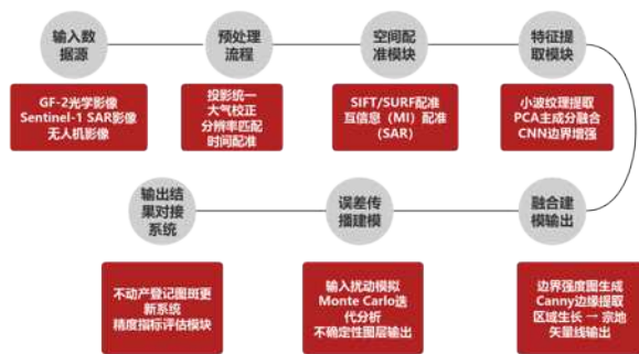
图 1 多源遥感数据融合与边界提取处理流程
