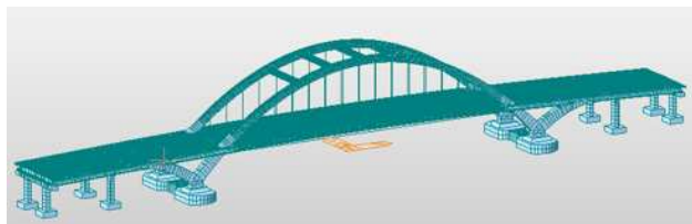
图 2 主桥有限元模型
