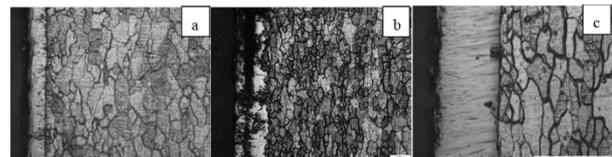
图 2 NH<sub>4</sub>Cl 在 (a)1050 $^{\circ}\text{C}$ ;(b)1200 $^{\circ}\text{C}$ ;(c)1300 $^{\circ}\text{C}$ 温度下渗硅试样的显微组织
