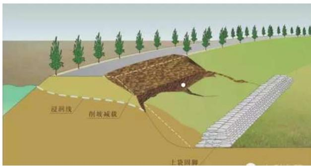
图2.1 堤防位移坍塌加固图
