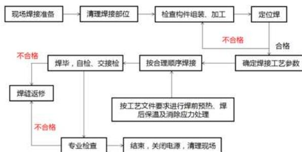
焊接前要求进行焊缝工艺评定, 焊丝和焊条母材相匹配。
